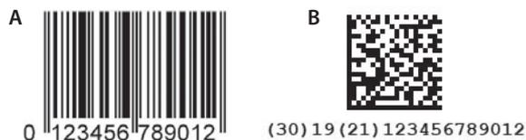
Figura 1. A. Código EAN 13. B. GS1 Datamatrix.
